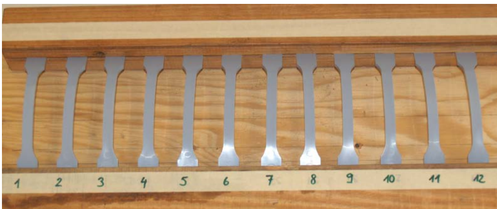
Abbildung 13 Spannungsrisssprüfung an Schulterstäben
