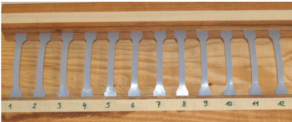
Abbildung 13 Spannungsrisssprüfung an Schulterstäben
